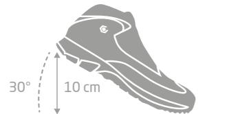
En moyenne, un travailleur fait environ 5 pas par minute, ce qui représente **2 400 pas en 8 heures**, soit 4 800 mouvements (des deux pieds). La chaussure doit fléchir d'environ 30° pour supporter le mouvement d'un pied lors d'un pas d'un mètre.
